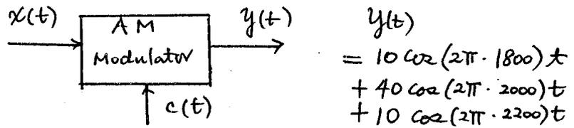
Where  $x(t)$ : Modulating signal,  $c(t)$ : carrier signal,  $y(t)$ : Modulated signal
