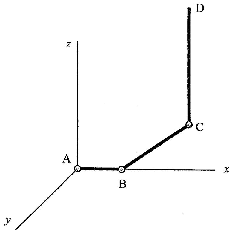
5. 一根鋼桿( $E = 30 \times 10^6$  psi)如下圖所示，其直徑為 0.85 in，在製造過程中必須獲得 100 in-lb 的彈性應變能，若假設永久變形的安全係數為 5，請求得該鋼桿材料的降伏強度。(20 %)
